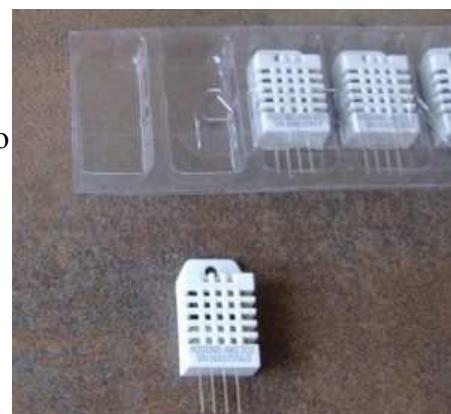
DHT22, также имеет обозначение AM2302
